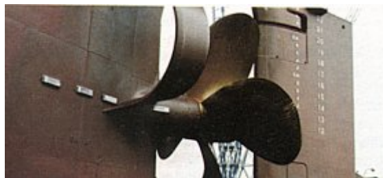
Opferanoden an einem Schiffsrumpf (aus [2, S. 231] )
