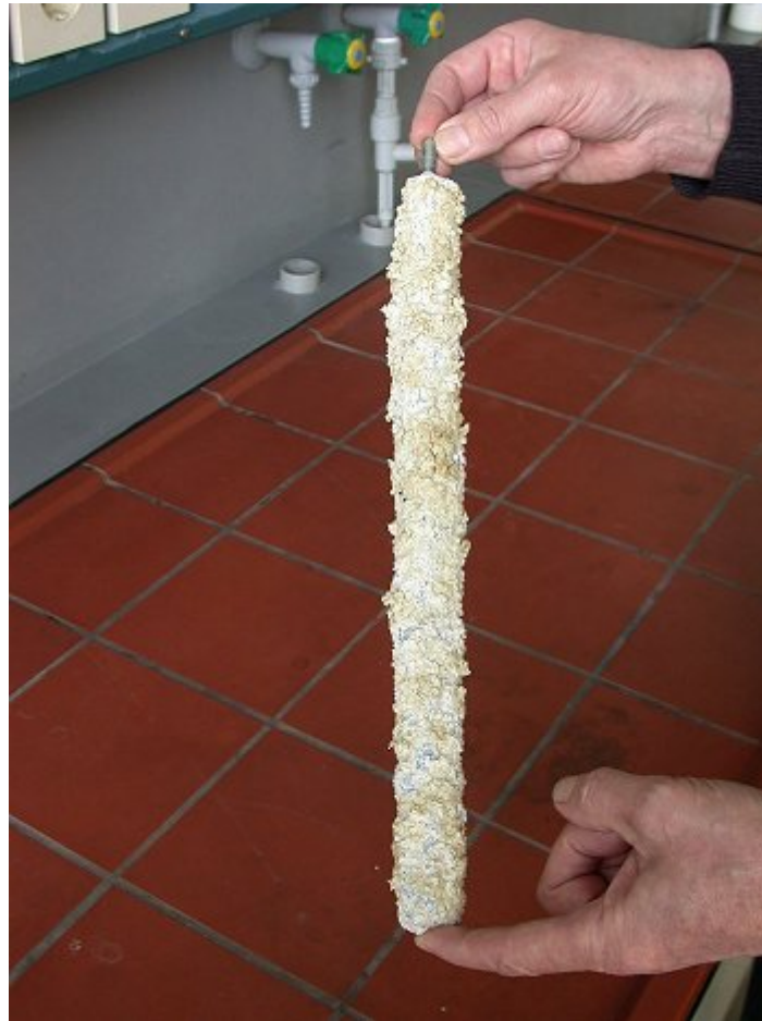
Verbrauchte Opferanode von Prof. Blumes Heizung. Der Überzug besteht aus harten, grobkristallinen Magnesiumverbindungen (Foto: Daggi)
